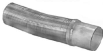
**COMPETITOR DANESE** Il flessibile cede particolarmente nella zona dell'accoppiamento tubo/flessibile a causa delle saldature abbastanza grossolane
